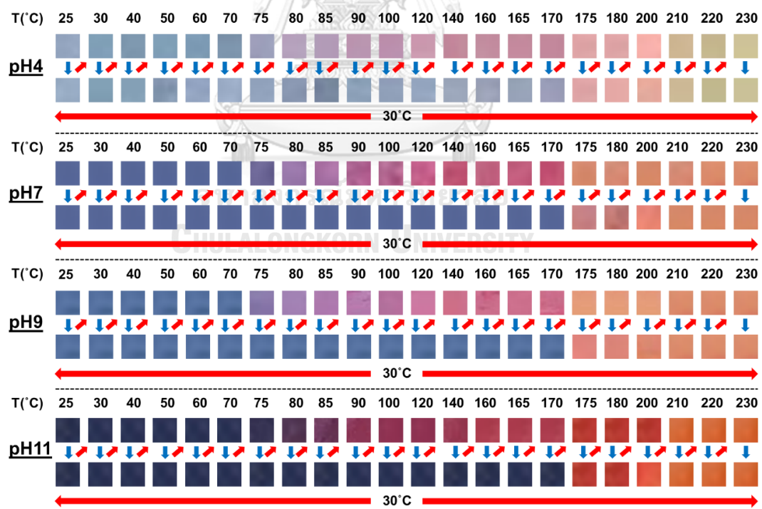
รูปที่ 4.16 ภาพถ่ายแสดงพฤติกรรมการเปลี่ยนสีของฟิล์มวัสดุเชิงประกอบระดับนาโนเมตร poly(PCDA)/Zn 2+ /SiO 2 ที่เตรียมในช่วง pH4 pH7 pH9 และ pH11 เมื่อได้รับความร้อนตั้งแต่อุณหภูมิ 25 ถึง 230 องศาเซลเซียสและปล่อยให้เย็นตัวลงที่อุณหภูมิห้อง
