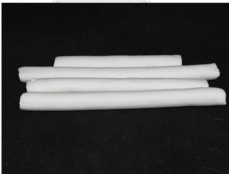
ภาพที่ 3-7 ภาพชิ้นงานอะลูมินาที่ขึ้นรูปด้วยวิธีการอัดรีด
