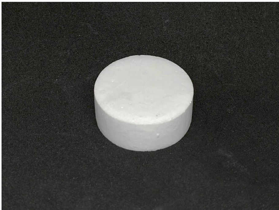
ภาพที่ 3-6 ภาพชิ้นอะลูมินาที่เตรียมเป็นเนื้อดินปั้นแล้วนำไปอัดด้วยเครื่องอัดไฮดรอลิก
