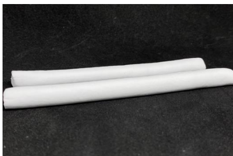
ภาพที่ 4-21 ภาพชิ้นงานอะลูมินาเมื่อใส่สารตัวเติมและขึ้นรูปด้วยกระบวนการอัดรีดหลังการเผาผลาญที่อุณหภูมิ 1550-1600 องศาเซลเซียส
