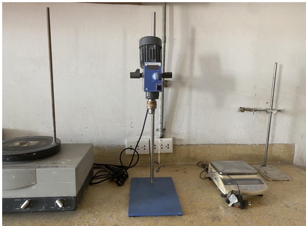
ภาพที่ ก-5-2 เครื่องปั่นผสมสารละลายเชิงประสาน
