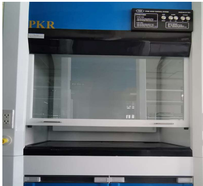
รูปที่ 3.4 ตู้ดูดควัน (Hood)
