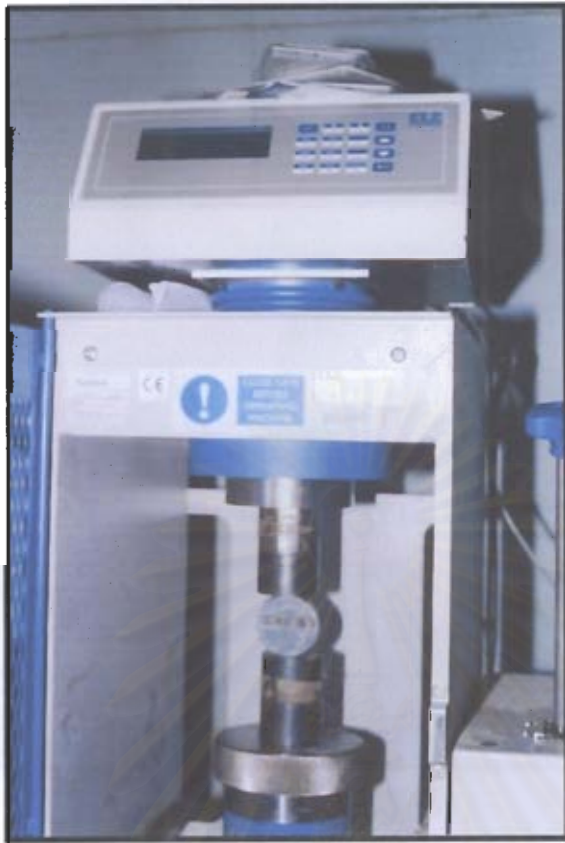
รูปที่ 6.8 การทดสอบหินเพื่อหาค่ากำลังวัสดุดึงทางอ้อมด้วยวิธี Brazilian test
