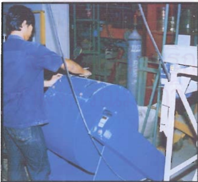
รูปที่ 6.5 เครื่องมือทดสอบความคงทนต่อการสึกกร่อนของหินมวลรวม
