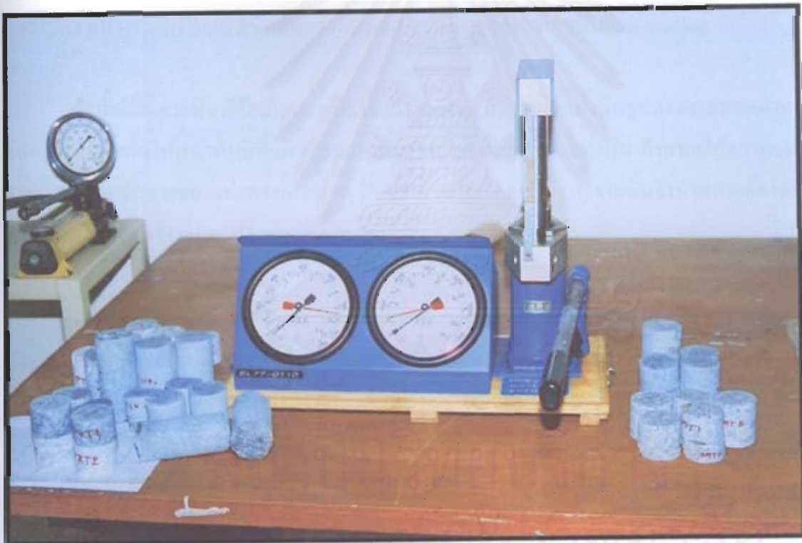
รูปที่ 6.2 การกดอัดหินแกรนิตรูปทรงกระบอก ด้วยเครื่องมือ point load test
