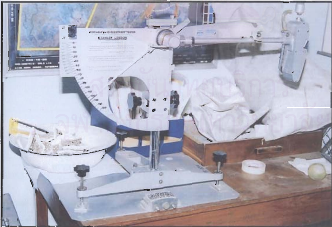
รูปที่ 6.7 เครื่องมือ BPT ที่ใช้ทดสอบความต้านทานต่อการเลื่อนไถลของผิวหินมวลรวม
