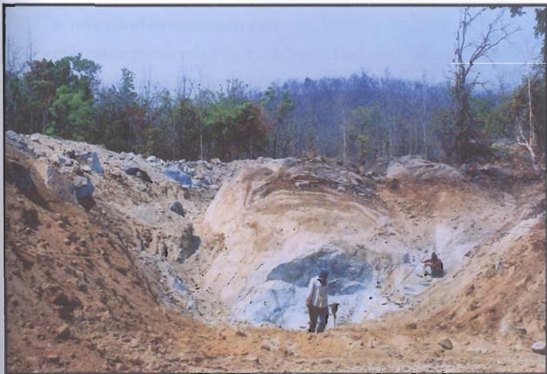
รูปที่ 5.17 ภาพถ่ายหน้าเหมืองแกรนิตได้ในปี 2547 ที่ทำการผลิตหินประดับชนิดแกรนิต
