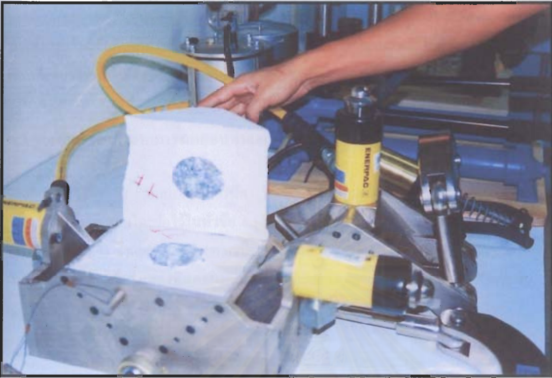
รูปที่ 6.10 เครื่องมือทดสอบหาค่ากำลังวัสดุเฉือน และยังใช้หาค่าคุณสมบัติอื่นที่ใกล้เคียง
