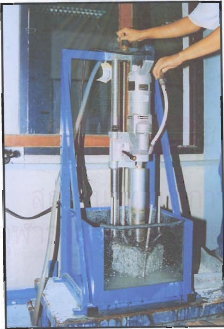
รูปที่ 6.1 การเจาะหินเป็นก้อนด้วย coring machine เพื่อให้ได้แท่งหินรูปทรงกระบอก
