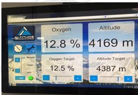
รูปที่ 20 หน้าจอแสดงค่าการทำงานของห้องจำลองสภาวะปริมาณออกซิเจนต่ำ
