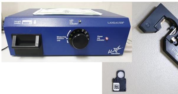
รูปที่ 4: เครื่อง OSL reader (MicroStar, Landauer®) สำหรับอ่านค่าปริมาณรังสีกระเจิงกลับจากแผ่นวัดรังสีไอเอสแอลโดยจะได้ค่าปริมาณรังสีออกมาในหน่วย cGy
