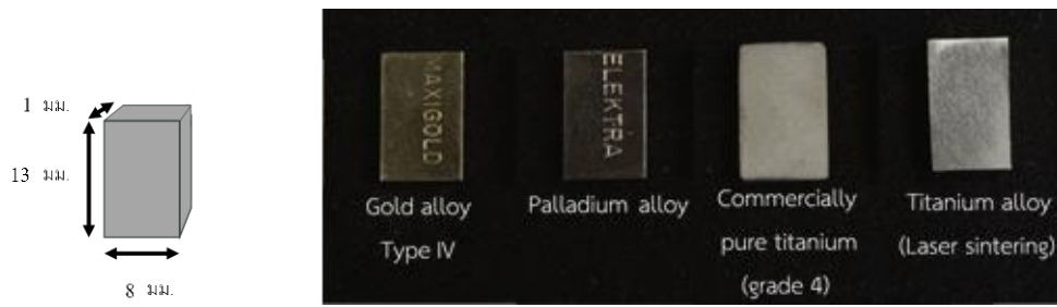
รูปที่ 5: วัสดุทางทันตกรรมชนิดโลหะ 4 ชนิด ขนาดของชิ้นงาน 8x13x1 มม. 3 (เรียงลำดับจากซ้ายไปขวา: โลหะผสมทอง, แพลลาเดียมอัลลอย, ไทเทเนียมบริสุทธิ์เชิงพาณิชย์ (ระดับ 4) และ ไทเทเนียมอัลลอยที่ผลิตโดยวิธีเลเซอร์เผาผนึก)
