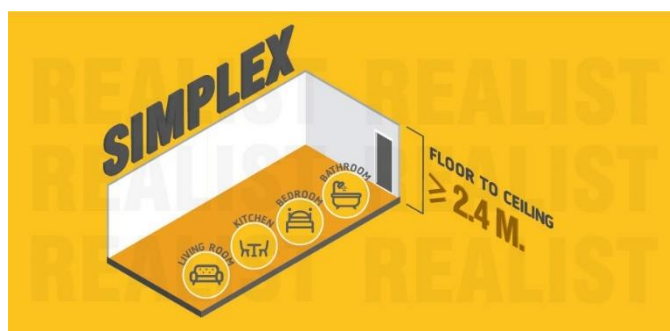
ภาพที่ 2.1 ระยะความสูงจากพื้นถึงพื้นของห้องชุดแบบ Simplex (Development, 2560)
