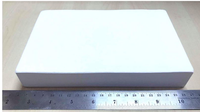
รูปที่ 4.42 ชิ้นงานขนาดใหญ่ที่มีปริมาณปูนซีเมนต์อะลูมินาสูงร้อยละ 10 โดยน้ำหนัก เผาที่อุณหภูมิ 1100 องศาเซลเซียส
