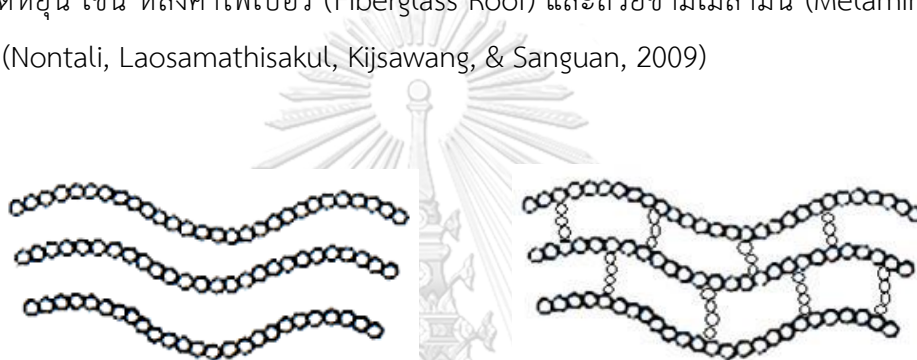
รูปที่ 12 โครงสร้างพอลิเมอร์แบบเส้น (ซ้าย) และโครงสร้างพอลิเมอร์แบบเชื่อมขวาง (ขวา) (Nontali et al., 2009)
