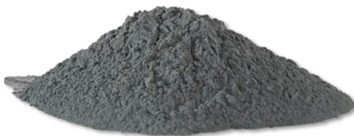
ภาพที่ 2.3 ฝุ่นผงสังกะสีจากกระบวนการชุบเคลือบสังกะสีแบบจุ่มร้อน
