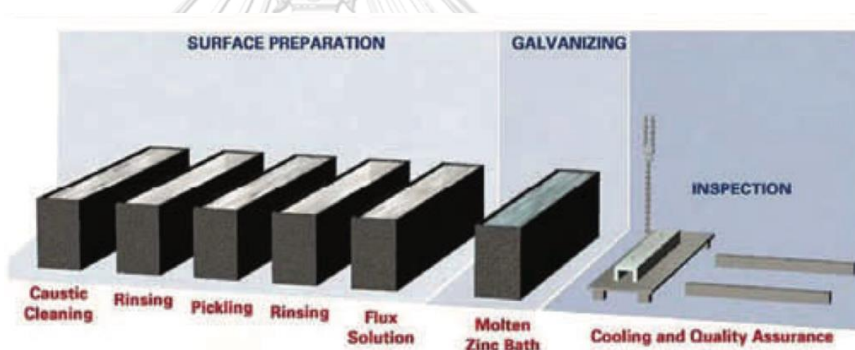
จุฬาลงกรณ์มหาวิทยาลัย ภาพที่ 2.2 ขั้นตอนการการชุบเคลือบสังกะสีแบบจุ่มร้อน [12]
