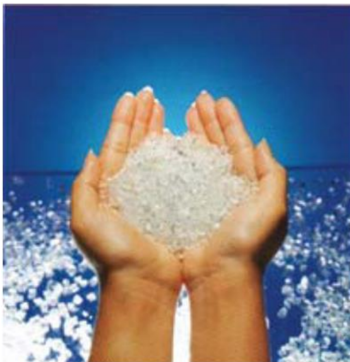
รูปที่ 2-2 ลักษณะการแตกเป็นเม็ดข้าวโพด ของกระจกเทมเปอร์ [3]
