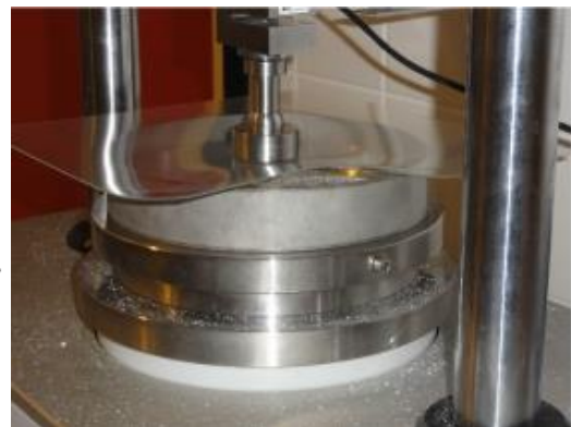
รูปที่ 2-11 รายละเอียดอุปกรณ์การทดสอบกระຈกตามมาตรฐาน EN1288-5 [2, 7]
