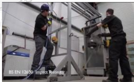
รูปที่ 2-12 รายละเอียดอุปกรณ์การทดสอบกระจกแตกเนื่องจากแรงกระแทก ตามมาตรฐาน มอก 965-2560 (EN 12600) [2, 8, 9]
