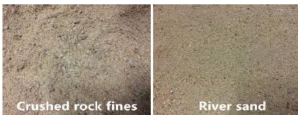
รูปที่ 2.2 หินบดละเอียดและทรายแม่น้ำที่ใช้เป็นวัสดุมวลรวมละเอียด (Fan and Li, 2017)
