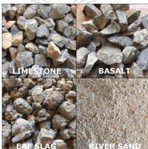
รูปที่ 2.8 วัสดุมวลรวมหยาบและละเอียดที่ใช้
