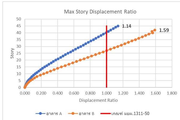
รูปที่ 5.3 สัดส่วนการเคลื่อนตัวด้านข้าง (Displacement Ratio) เนื่องจากแรงลม ของอาคาร A และ B
