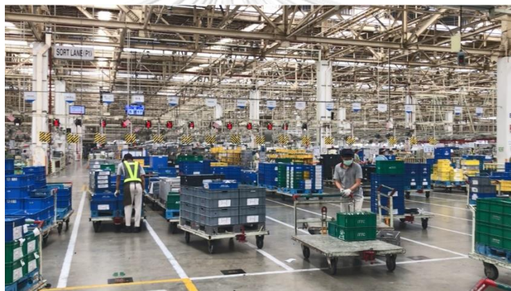
รูปที่ 1-10 พื้นที่คัดแยกกล่องขึ้นส่วนตามจุดความต้องการ (Address)
