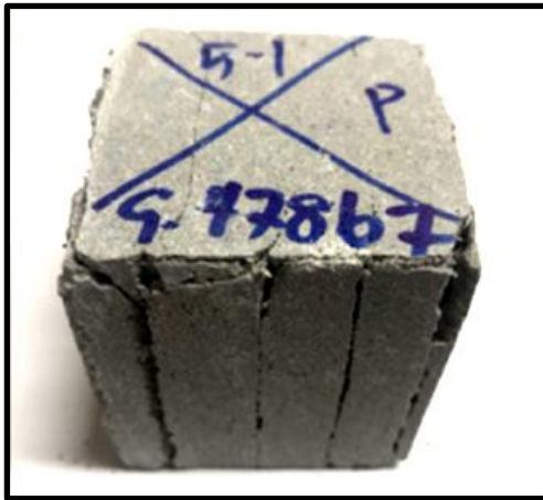
(ก) ชิ้นงานตัวอย่างแบบ Parallel
