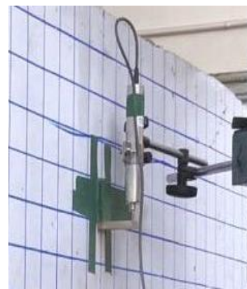
(ค) การติดตั้ง LVDT
