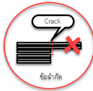
รูปที่ 8 ตัวอย่างข้อจำกัดของการพิมพ์ที่เป็นคานยื่น
