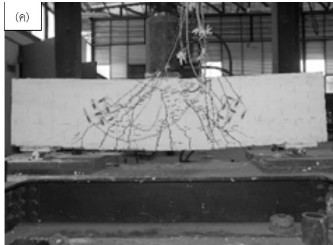
รูปที่ 24 ตัวอย่างลักษณะการวิบัติของคานลึกลับจากงานวิจัยของ อมรภิญโญ and ธีระวงษ์ (2017)
