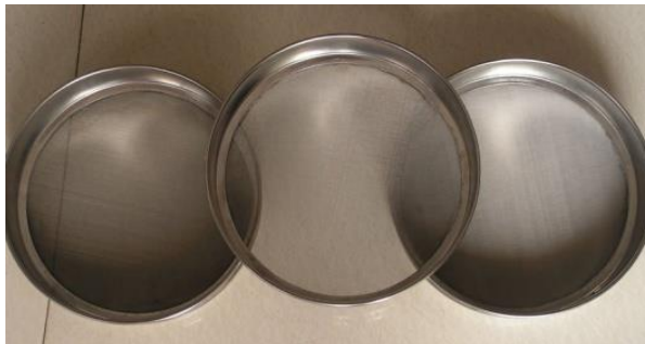
รูปที่ 3.7 รูปภาพแสดงให้เห็นลักษณะของตะแกรงคัดขนาดเกล็ดเปลือกหอยแมลงภู่ที่ผ่านการบดย่อยแล้วให้มีขนาดตามต้องการ
