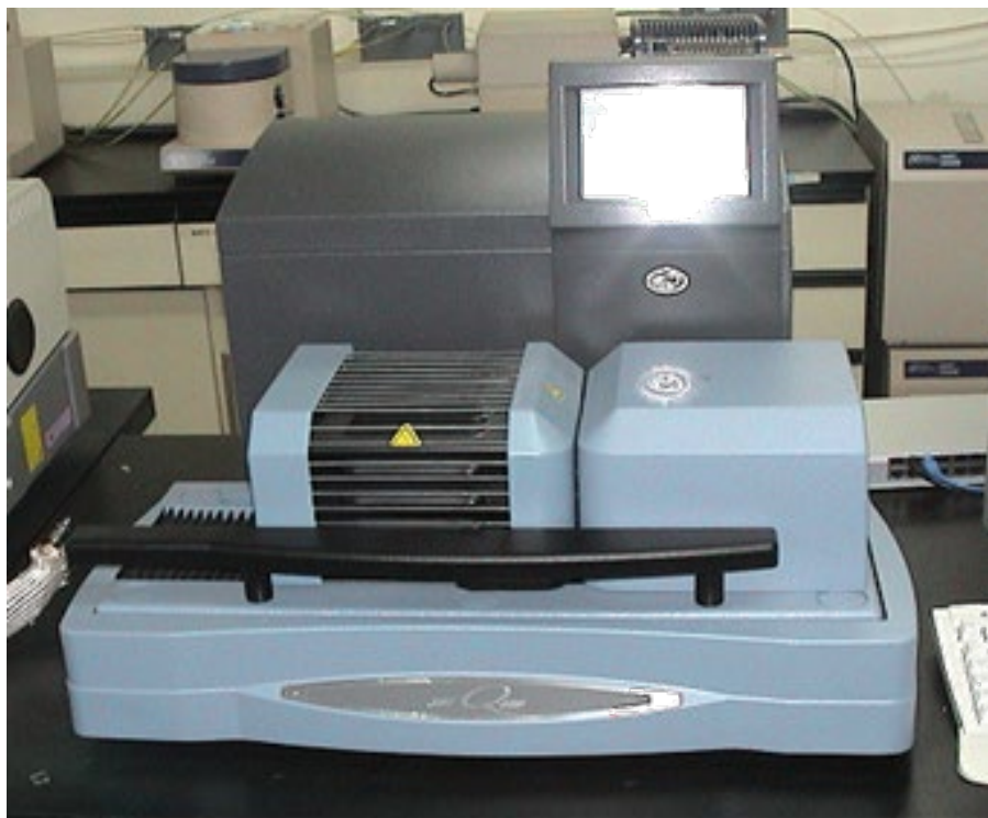
รูปที่ 3.8 Thermal gravimetric analysis (รุ่น Q600)
