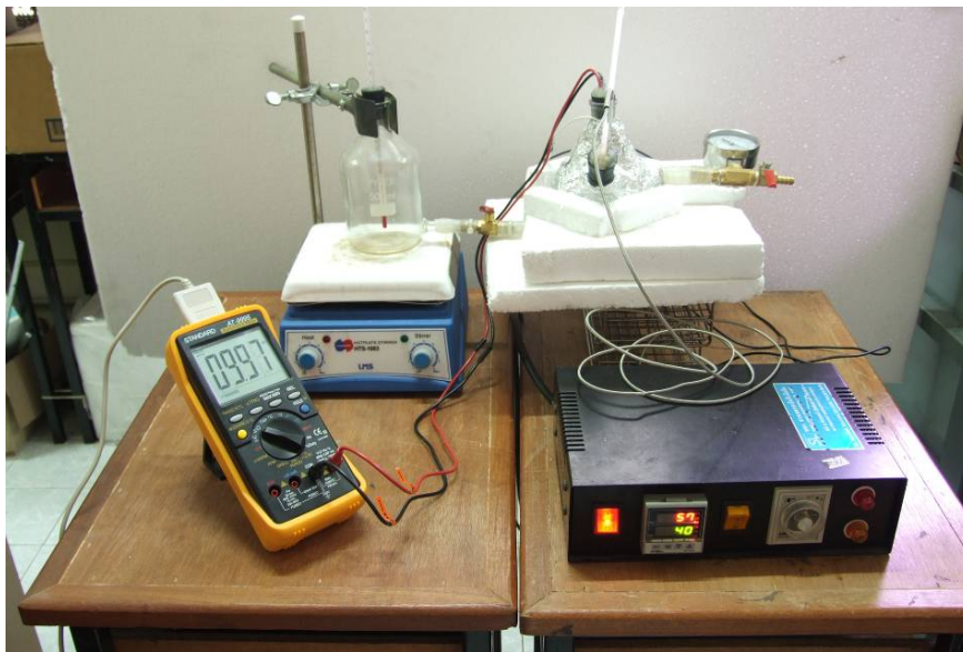
รูปที่ 3.4 ภาพถ่ายอุปกรณ์สำหรับทดลองวัดค่าการเปลี่ยนแปลงความต้านทานของตัวตรวจวัดก๊าซ
