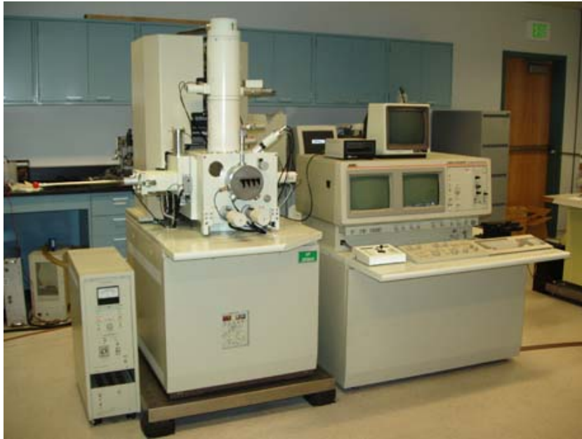
รูปที่ 3.6 Field Emission Scanning Electron Microscopy (JEOL รุ่น JSM-6400)
