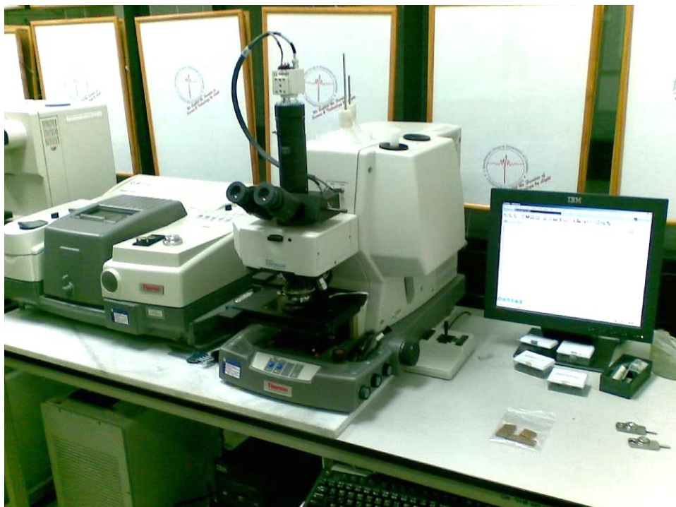
รูปที่ 3.7 Fourier Transform Infrared Spectroscopy (FTIR) (รุ่น 1760x)
