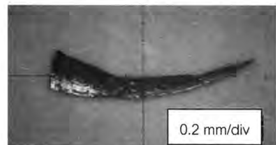
รูปที่ 7.8 ลักษณะเศษโลหะที่ความเร็วรอบ 3,000 รอบต่อนาที อัตราป้อนตัด 0.01 มิลลิเมตรต่อรอบ ความลึกตัด 1 มิลลิเมตรของการตัดแบบเปียก (อัตราส่วน 0.2 มิลลิเมตรต่อ 1 ช่อง)
