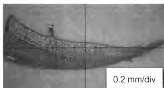
รูปที่ 7.34 ลักษณะเศษโลหะที่ความเร็วรอบ 1,000 รอบต่อนาที อัตราป้อนตัด 0.02 มิลลิเมตรต่อรอบ ความลึกตัด 1.5 มิลลิเมตรของการตัดแบบละเอียดของสารหล่อเย็น (อัตราส่วน 0.2 มิลลิเมตรต่อ 1 ช่อง)
