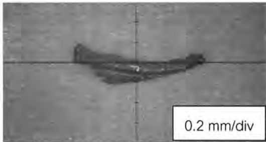
รูปที่ 7.21 ลักษณะเศษโลหะที่ความเร็วรอบ 1,000 รอบต่อนาที อัตราป้อนตัด 0.02 มิลลิเมตรต่อรอบ ความลึกตัด 0.5 มิลลิเมตร ของการตัดแบบลมเป่า (อัตราส่วน 0.2 มิลลิเมตรต่อ 1 ช่อง)
