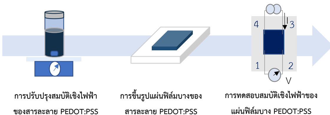
รูปที่ 3. 1 กระบวนการเตรียมสารละลาย PEDOT:PSS สำหรับใช้เป็นวัสดุเทอร์โมอิเล็กทริก
