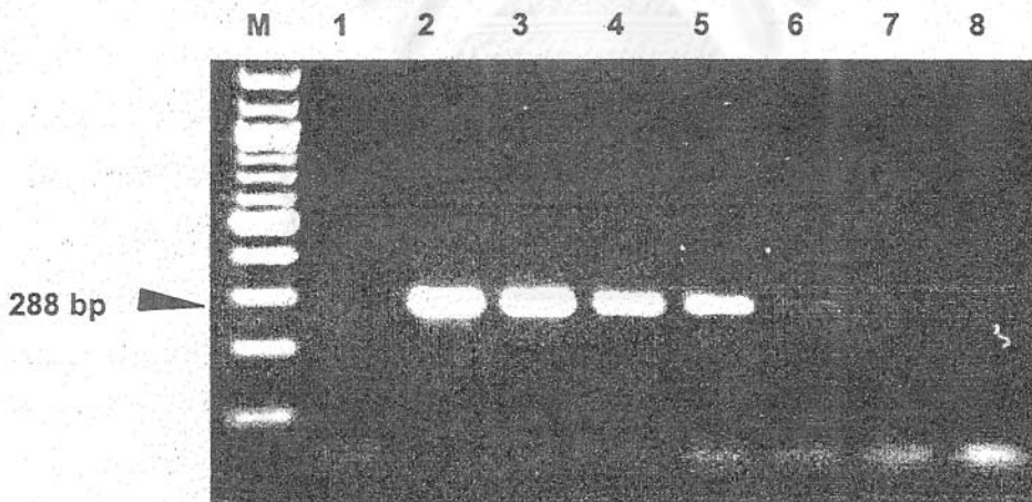
รูปที่ 2.1.1.4 แสดงความไวของวิธี RT-PCR ในการตรวจหาสารพันธุกรรมของไวรัสอหิวาต์สุกรสายพันธุ์ ALD ในเซลล์เพาะเลี้ยง เปรียบเทียบกับ media สำหรับเลี้ยงเซลล์ โดยใช้ primer 324 และ 326 M = 100 bp ladder marker, 1 = media, 2-8 = ผลผลิตที่ได้จากไวรัสอหิวาต์สุกรสายพันธุ์ ALD ที่ความเข้มข้น 6-0 log TCID 50 ตามลำดับ
