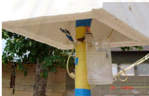
รูปที่ 3-14 แสดงการเก็บข้อมูลอุณหภูมิกระเปาะแห้งและกระเปาะเปียกภายนอกอาคารทดลอง
