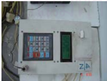
รูปที่ 3-1 แสดงการติดตั้งเครื่องเก็บข้อมูลอัตโนมัติ (Data Logger)
