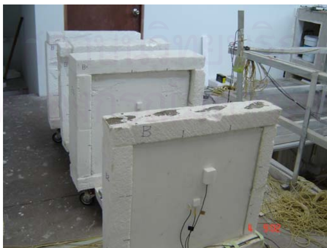
รูปที่ 3-6 แสดงการเก็บข้อมูลภายในอาคารทดสอบ ช่วงสภาวะเปิดระบบปรับอากาศ
