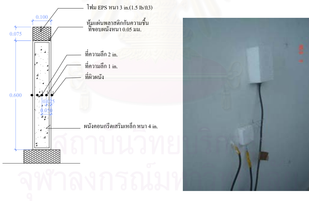
รูปที่ 3-10 แสดงตำแหน่งการติดตั้งหัววัดอุณหภูมิ ณ ที่ผิวผนัง และที่ความลึก 1 และ 2 นิ้วจากผิวผนัง
