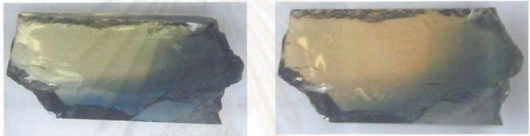
รูปที่ 3.4 พลอยบุษราคัมบางกะจะสดที่มีแถบสีน้ำเงินเขียว ตัวอย่าง YGCH1 มีสีเหลืองอ่อนก่อนเผา (รูปซ้าย) ปรากฏเป็นสีเหลืองทอง หรือสีเหลืองแกมน้ำตาล (สีแม่โขง) ที่หลังเผาที่อุณหภูมิ 1,650^{\circ}\text{C} เป็นเวลา 10 ชั่วโมง ในบรรยากาศออกซิเจนบริสุทธิ์ (รูปขวา) โปรดสังเกตแถบสีน้ำเงินเขียวที่สีจางลงเล็กน้อยหลังเผา (ถ่ายภาพโดยชนิยา สมบุญ)
