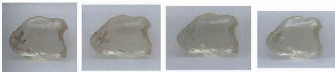
รูปที่ 5.8 แสดงตัวอย่างพลอยแซปไฟร์ Ymd4 ที่มีสีเหลืองอ่อนมากก่อนเผา (รูปซ้าย สีน้ำตาลบริเวณขอบเกิดจากคราบสนิมเหล็ก) หลังเผาที่ 1650^{\circ}\text{C} ปรากฏว่าแทบไม่เปลี่ยนสีเมื่อเผาอบ 10 ชั่วโมง (รูปกลางซ้าย) เผาอบ 24 ชั่วโมง (รูปกลางขวา) และเผายก (รูปขวา) ตามลำดับ ตัวอย่างนี้มี Fe เฉลี่ย 1,555.3 amp และ หนา 2.12-2.65 มม
