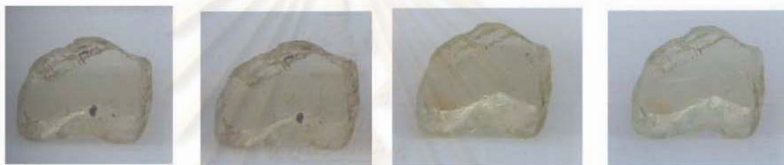
รูปที่ 5.8 แสดงตัวอย่างพลอยแซปไฟร์ Ymd4 ที่มีสีเหลืองอ่อนมากก่อนเผา (รูปซ้าย สีน้ำตาลบริเวณขอบเกิดจากคราบสนิมเหล็ก) หลังเผาที่ 1650^{\circ}\text{C} ปรากฏว่าแทบไม่เปลี่ยนสีเมื่อเผาอบ 10 ชั่วโมง (รูปกลางซ้าย) เผาอบ 24 ชั่วโมง (รูปกลางขวา) และเผายก (รูปขวา) ตามลำดับ ตัวอย่างนี้มี Fe เฉลี่ย 1,555.3 amp และ หนา 2.12-2.65 มม
