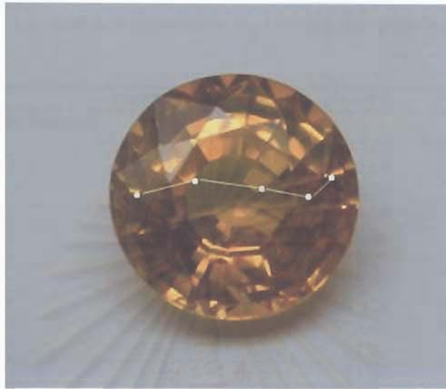
รูปที่ 2.20 แสดงตำแหน่งที่ทำการวิเคราะห์จำนวน 5 จุดจากซ้ายไปขวา บนด้านหน้าของพลอยบุษราคัมศรีลังกา ตัวอย่าง PC3 ด้วยเครื่องมือ LA-ICP-MS
