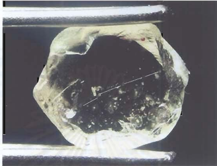
รูปที่ 5.49 ภาพขยายของตัวอย่าง Ymd9 เผาแล้วสีเหมือนเดิม แสดงตำแหน่งที่ทำการวิเคราะห์จำนวน 5 จุดด้วย เครื่องมือ LA-ICP-MS
