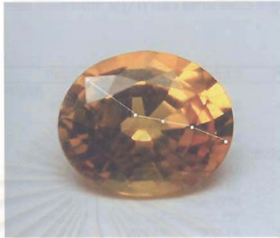
รูปที่ 2.16 แสดงตำแหน่งที่ทำการวิเคราะห์จำนวน 5 จุดจากซ้ายไปขวา บนด้านหน้าของพลอยบุษราคัมศรีลังกา ตัวอย่าง PC1 ด้วยเครื่องมือ LA-ICP-MS
