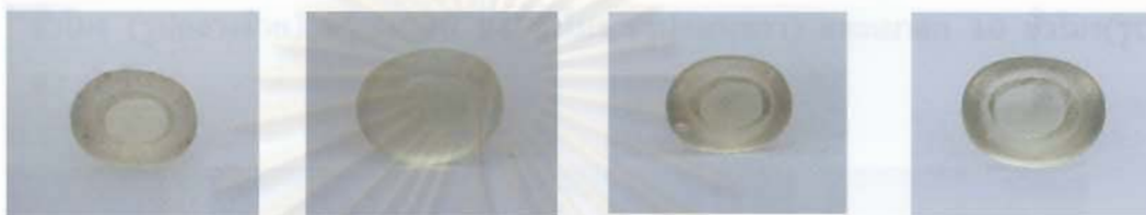
รูปที่ 4.1 แสดงตัวอย่างพลอยแซปไฟร์ CH1 ที่มีสีเหลืองอ่อนก่อนเผา (รูปซ้าย) หลังเผาที่ 1650^{\circ}\text{C} ในบรรยากาศออกซิเจนบริสุทธิ์ ปรากฏว่าสียังเหมือนเดิมเมื่อเผาอบ 10 ชั่วโมง (รูปกลางซ้าย) หรือเผาอบ 24 ชั่วโมง (รูปกลางขวา) และเผายก 10 ชั่วโมง (รูปขวา) ตามลำดับ
