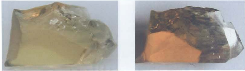
รูปที่ 3.3 พลอยบุษราคัมบางกะจะสด ตัวอย่าง YCH3 ที่มีสีเหลืองอ่อนก่อนเผา (รูปซ้าย) ปรากฏเป็นสีเหลืองทอง หรือสีเหลืองแกมน้ำตาล (สีแม่โขง) ที่เสถียร หลังเผาที่อุณหภูมิ 1,650^{\circ}\text{C} เป็นเวลา 10 ชั่วโมง ในบรรยากาศออกซิเจนบริสุทธิ์ (รูปขวา) (ถ่ายภาพโดยชนิยา สมบุญ)
