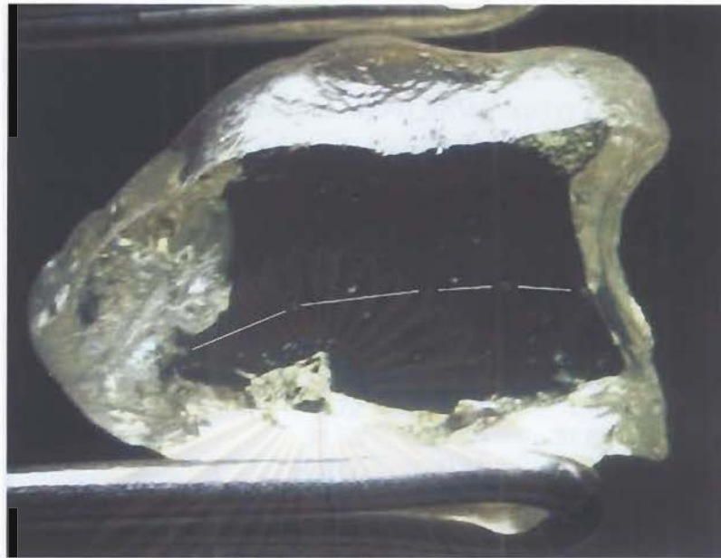
รูปที่ 5.55 ภาพขยายของตัวอย่าง Ymd4 เผาแล้วสีเหมือนเดิม แสดงตำแหน่งที่ทำการวิเคราะห์จำนวน 5 จุดด้วยเครื่องมือ LA-ICP-MS
