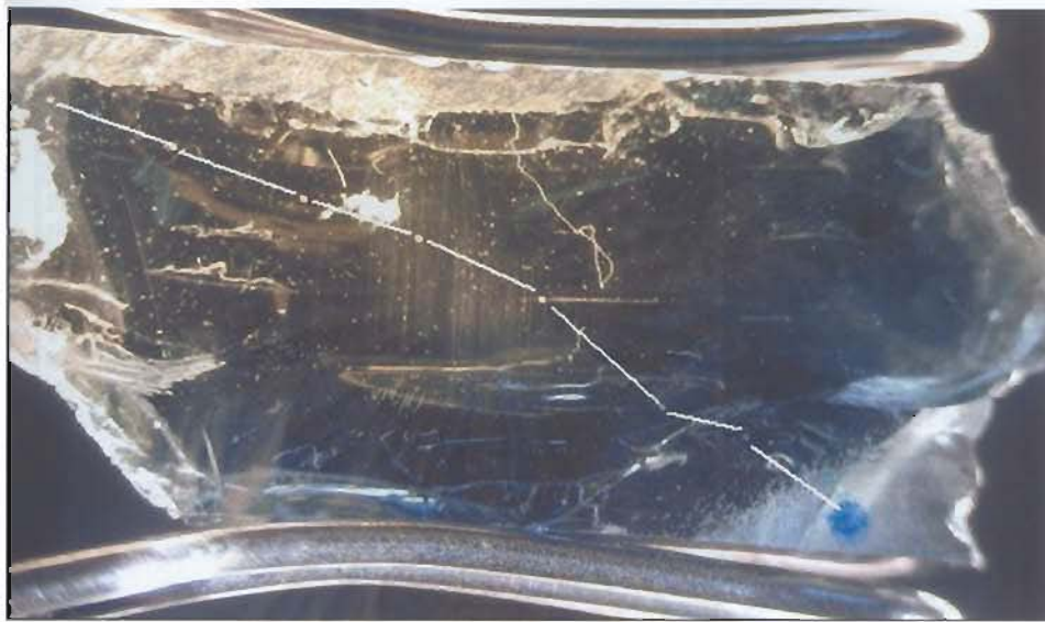
รูปที่ 3.27 แสดงจุดที่ทำการวิเคราะห์จากซ้ายไปขวา จำนวน 8 จุด บนผิวพอลอยบุษราคัมบางกะจะ ตัวอย่าง YGCH1 ด้วยเครื่องมือ LA-ICP-MS จุดที่ 1-5 จากซ้ายอยู่ในส่วนสีเหลือง จุดที่ 6-8 อยู่ในแถบสีน้ำเงินเขียว
