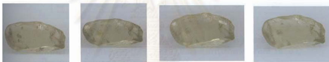
รูปที่ 5.12 แสดงตัวอย่างพลอยแซปไฟร์ Ymd11 ที่มีสีเหลืองอ่อนก่อนเผา (รูปซ้าย) หลังเผาที่ 1650^{\circ}\text{C} ปรากฏว่าแทบไม่เปลี่ยนสีเมื่อเผาอบ 10 ชั่วโมง (รูปกลางซ้าย) เผาอบ 24 ชั่วโมง (รูปกลางขวา) และเผายก (รูปขวา) ตามลำดับ ตัวอย่างนี้มี Fe เฉลี่ย 2,883.5 amp และ ทน 1.40-1.46 มม
