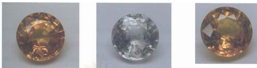
รูปที่ 2.3 พลอยบุษราคัมศรีลังกาเผาแล้ว (PC3) มีสีเหลืองทอง (ซ้าย) เปลี่ยนเป็นไร้สีหลังเผาครั้งที่หนึ่งในบรรยากาศแบบขาดออกซิเจน (กลาง) และเปลี่ยนกลับไปเป็นสีเหลืองทองเหมือนเดิม เมื่อเผาครั้งที่สองในบรรยากาศแบบออกซิเจนพอเพียง (ขวา)
