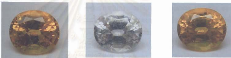
รูปที่ 2.4 พลอยบุษราคัมศรีลังกาเผาแล้ว (PC4) มีสีเหลืองทอง (ซ้าย) เปลี่ยนเป็นไร้สีหลังเผาครั้งที่หนึ่งในบรรยากาศแบบขาดออกซิเจน (กลาง) และเปลี่ยนกลับไปเป็นสีเหลืองทองเหมือนเดิม เมื่อเผาครั้งที่สองในบรรยากาศแบบออกซิเจนพอเพียง (ขวา)
