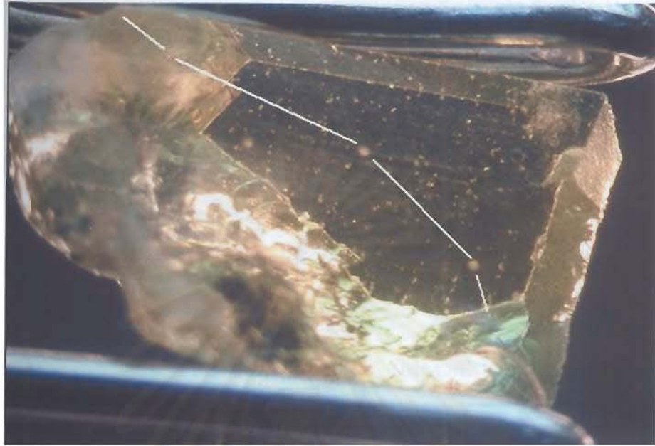
รูปที่ 3.25 แสดงจุดที่ทำการวิเคราะห์จากซ้ายไปขวา จำนวน 5 จุด บนผิวพลอยบุซราคัมบางกะจะ ตัวอย่าง YCH3 ด้วยเครื่องมือ LA-ICP-MS
