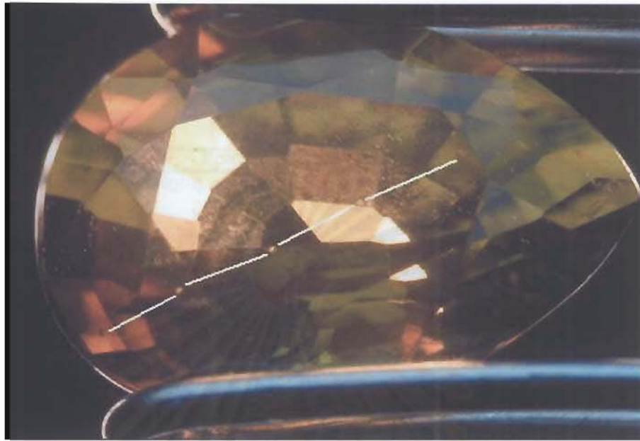
รูปที่ 3.23 แสดงจุดที่ทำการวิเคราะห์จากซ้ายไปขวา จำนวน 5 จุด บนผิวพลอยบุษราคัมบางกะจะ ตัวอย่าง YCH2 ด้วยเครื่องมือ LA-ICP-MS
