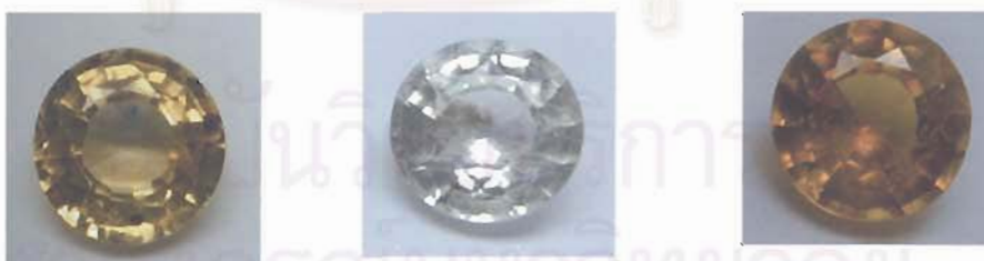
รูปที่ 2.5 พลอยบุษราคัมศรีลังกาเผาแล้ว (PC5) มีสีเหลือง (ซ้าย) เปลี่ยนเป็นไร้สีหลังเผาครั้งที่หนึ่งในบรรยากาศแบบขาดออกซิเจน (กลาง) และเปลี่ยนกลับไปเป็นสีเหลืองทอง เมื่อเผาครั้งที่สองในบรรยากาศแบบออกซิเจนพอเพียง (ขวา)
