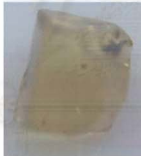
รูปที่ 3.2 พลอยบุษราคัมบางกะจะ ตัวอย่าง YCH2 ที่มีสีเหลืองอ่อนก่อนเผา (รูปซ้ายแสดงสีก่อนเผาและ ก่อนเจียรระไน) ปรากฏเป็นสีเหลืองทอง หรือสีเหลืองแกมน้ำตาล (สีแม็ซง) ที่เสถียร หลังเผาที่ อุณหภูมิ 1,600^{\circ}\text{C} เป็นเวลา 6 ชั่วโมง ในอากาศปรกติ (รูปขวาหลังจากเจียรระไน) (เผาโดยคุณ รัก ธรรมชาติ และ ถ่ายภาพโดย ชนิตา สมบุญ)
