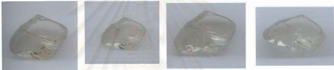
รูปที่ 5.6 แสดงตัวอย่างพลอยแซปไฟร์ Ymd2 ที่ไร้สีก่อนเผา (รูปซ้าย สีนํ้าตาลบริเวณขอบเกิดจากคราบสนิมเหล็ก) หลังเผาที่ 1650°C ปรากฏว่าแทบไม่เปลี่ยนสีเมื่อเผาอบ 10 ชั่วโมง (รูปกลางซ้าย) เผาอบ 24 ชั่วโมง (รูปกลางขวา) และเผายก (รูปขวา) ตามลำดับ ตัวอย่างนี้มี Fe เฉลี่ย 1,137.8 amp และ ทน 2.27-2.44 มม
