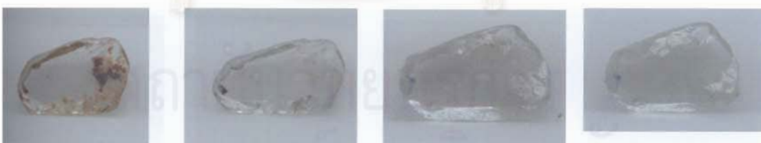
รูปที่ 5.4 แสดงตัวอย่างพลอยแซปไฟร์ Ymd5 ที่ไร้สีก่อนเผา (รูปซ้าย) สีนํ้าตาลบริเวณขอบเกิดจากคราบสนิมเหล็ก) หลังเผาที่ 1650°C ปรากฏว่าแทบไม่เปลี่ยนสีเมื่อเผาอบ 10 ชั่วโมง (รูปกลางซ้าย) เผาอบ 24 ชั่วโมง (รูปกลางขวา) และเผายก (รูปขวา) ตามลำดับ ตัวอย่างนี้มี Fe เฉลี่ย 768.4 amp และ หนา 1.38-2.38 มม
