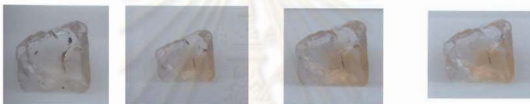
รูปที่ 5.3 แสดงตัวอย่างพลอยแซปไฟร์ Ymd1 ที่ไร้สีก่อนเผา (รูปซ้าย) หลังเผาที่ 1650°C ปรากฏเป็นสีเหลืองทองบางจุดที่คงทนเมื่อเผาอบ 10 ชั่วโมง (รูปกลางซ้าย) เผาอบ 24 ชั่วโมง (รูปกลางขวา) และเผายก (รูปขวา) ตามลำดับ ตัวอย่างนี้มี Fe เฉลี่ย 474.3 amp และ หนา 2.19-2.76 มม
