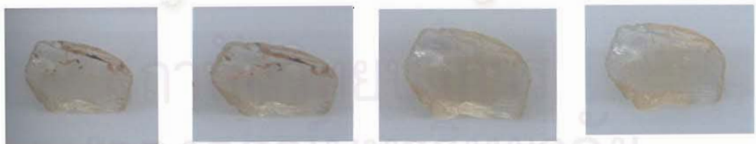
รูปที่ 5.7 แสดงตัวอย่างพลอยแซปไฟร์ Ymd12 ที่ไร้สีก่อนเผา (รูปซ้าย สีนํ้าตาลบริเวณขอบเกิดจากคราบสนิมเหล็ก) หลังเผาที่ 1650°C ปรากฏว่าแทบไม่เปลี่ยนสีเมื่อเผาอบ 10 ชั่วโมง (รูปกลางซ้าย) เผาอบ 24 ชั่วโมง (รูปกลางขวา) และเผายก (รูปขวา) ตามลำดับ ตัวอย่างนี้มี Fe เฉลี่ย 1,154.3 amp และ ทน 1.52-1.66 มม
