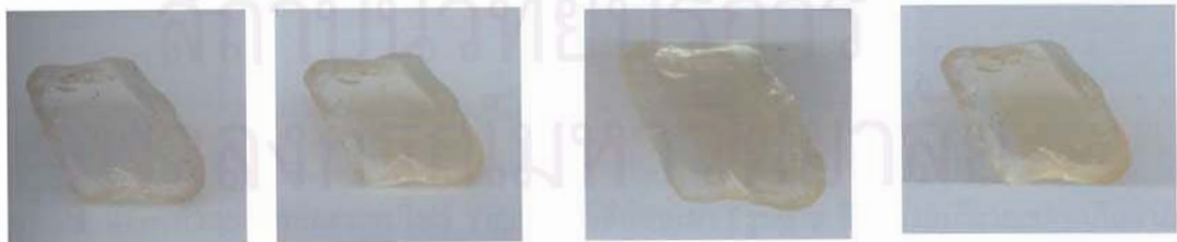
รูปที่ 5.1 แสดงตัวอย่างพลอยแซปไฟร์ Ymd7 ที่ไร้สีก่อนเผา (รูปซ้าย) หลังเผาที่ 1650^{\circ}\text{C} ปรากฏเป็นสีเหลืองเล็กน้อยที่คงทนเมื่อเผาอบ 10 ชั่วโมง (รูปกลางซ้าย) เผาอบ 24 ชั่วโมง (รูปกลางขวา) และเผายก (รูปขวา) ตามลำดับ ตัวอย่างนี้มี Fe เหลือ 51.6 amp และ หนา 1.67–2.36 มม
