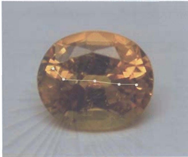
รูปที่ 2.22 แสดงตำแหน่งที่ทำการวิเคราะห์จำนวน 5 จุดจากซ้ายไปขวา บนด้านหน้าของพลอย บุชราคัมศรี ลังกา ตัวอย่าง PC4 ด้วยเครื่องมือ LA-ICP-MS
