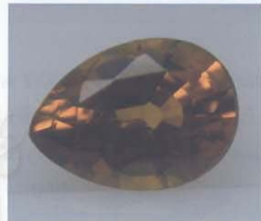
รูปที่ 3.2 พลอยบุษราคัมบางกะจะ ตัวอย่าง YCH2 ที่มีสีเหลืองอ่อนก่อนเผา (รูปซ้ายแสดงสีก่อนเผาและ ก่อนเจียรระไน) ปรากฏเป็นสีเหลืองทอง หรือสีเหลืองแกมน้ำตาล (สีแม็ซง) ที่เสถียร หลังเผาที่ อุณหภูมิ 1,600^{\circ}\text{C} เป็นเวลา 6 ชั่วโมง ในอากาศปรกติ (รูปขวาหลังจากเจียรระไน) (เผาโดยคุณ รัก ธรรมชาติ และ ถ่ายภาพโดย ชนิตา สมบุญ)
