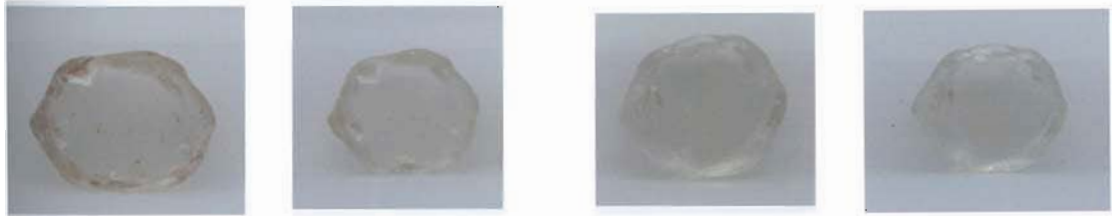
รูปที่ 5.5 แสดงตัวอย่างพลอยแซปไฟร์ Ymd9 ที่ไร้สีก่อนเผา (รูปซ้าย) สีนํ้าตาลบริเวณขอบเกิดจากคราบสนิมเหล็ก) หลังเผาที่ 1650°C ปรากฏว่าแทบไม่เปลี่ยนสีเมื่อเผาอบ 10 ชั่วโมง (รูปกลางซ้าย) เผาอบ 24 ชั่วโมง (รูปกลางขวา) และเผายก (รูปขวา) ตามลำดับ ตัวอย่างนี้มี Fe เฉลี่ย 805.3 amp และ ทน 1.69-1.85 มม
