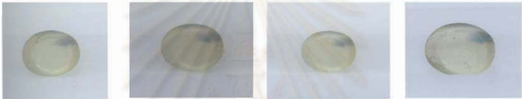
รูปที่ 4.4 แสดงตัวอย่างพลอยแซปไฟร์ CH 4 ที่มีสีเหลืองอ่อนและแถบเขียวบริเวณขอบก่อนเผา (รูปซ้าย) หลังเผาที่ 1650°C ในบรรยากาศออกซิเจนบริสุทธิ์ ปรากฏว่าสียังเหมือนเดิม เมื่อเผาอบ 10 ชั่วโมง (รูปกลางซ้าย) หรือเผาอบ 24 ชั่วโมง (รูปกลางขวา) และเผาอีก 10 ชั่วโมง (รูปขวา) ตามลำดับ
