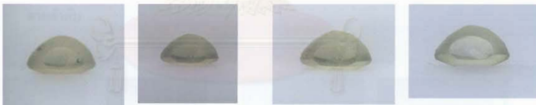
รูปที่ 4.2 แสดงตัวอย่างพลอยแซปไฟร์ CH2 ที่มีสีเหลืองแกมเขียวก่อนเผา (รูปซ้าย) หลังเผาที่ 1650^{\circ}\text{C} ในบรรยากาศออกซิเจนบริสุทธิ์ ปรากฏว่าสียังเหมือนเดิมเมื่อเผาอบ 10 ชั่วโมง (รูปกลางซ้าย) หรือเผาอบ 24 ชั่วโมง (รูปกลางขวา) และเผายก 10 ชั่วโมง (รูปขวา) ตามลำดับ
