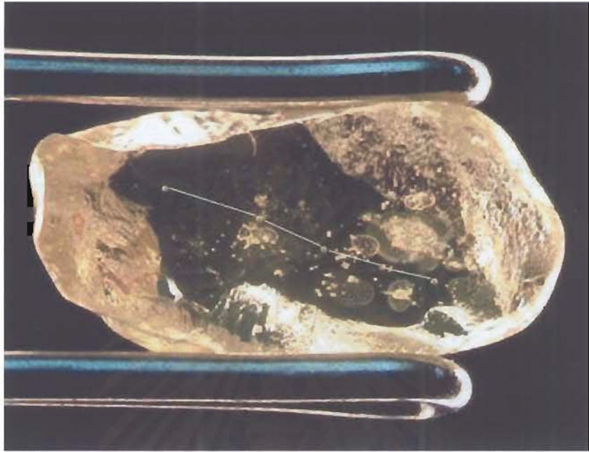
รูปที่ 5.63 ภาพขยายของตัวอย่าง Ymd11 เพลแล้วสีเหมือนเดิม แสดงตำแหน่งที่ทำการวิเคราะห์ จำนวน 5 จุดด้วยเครื่องมือ LA-ICP-MS
