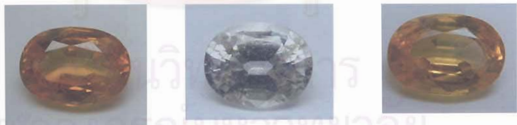
รูปที่ 2.1 พลอยบุษราคัมศรีลังกาเผาแล้ว (PC1) มีสีเหลืองทอง (ซ้าย) เปลี่ยนเป็นไร้สีหลังเผาครั้งที่หนึ่ง ในบรรยากาศแบบขาดออกซิเจน (กลาง) และเปลี่ยนกลับไปเป็นสีเหลืองทองเหมือนเดิม เมื่อเผาครั้งที่สองในบรรยากาศแบบออกซิเจนพอเพียง (ขวา)
