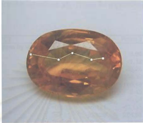
รูปที่ 2.18 แสดงตำแหน่งที่ทำการวิเคราะห์จำนวน 5 จุดจากซ้ายไปขวา บนด้านหน้าของพลอยบุษราคัมศรีลังกา ตัวอย่าง PC2 ด้วยเครื่องมือ LA-ICP-MS
