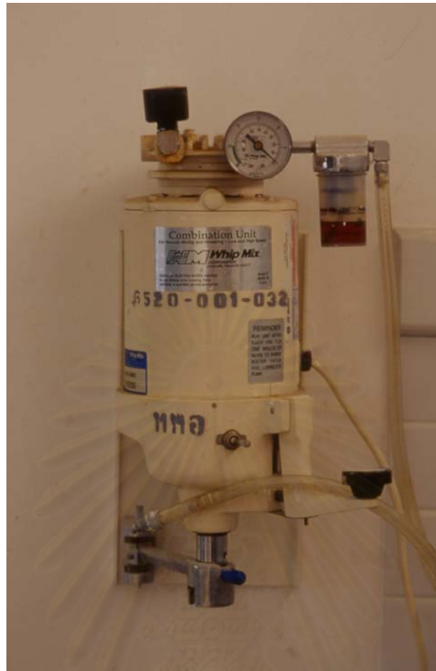
รูปที่ 26 เครื่องผสมสุญญากาศ
