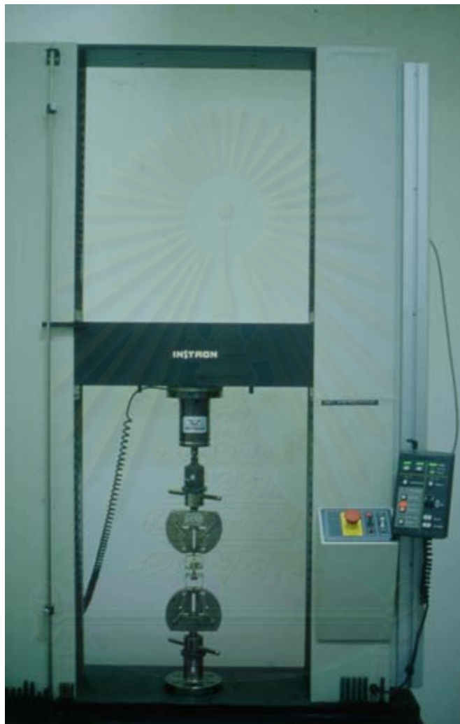
สถาบันวิทยบริการ จุฬาลงกรณ์มหาวิทยาลัย รูปที่ 46 เครื่องทดสอบสากล (Instron model 5583)
