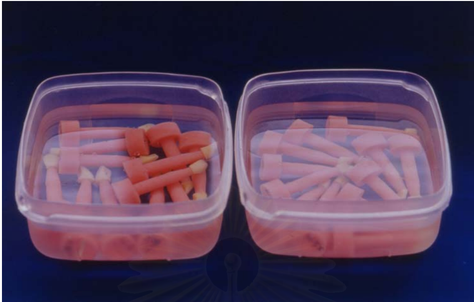
รูปที่ 41 ชั้นทดสอบแช่ในน้ำกลั่น
