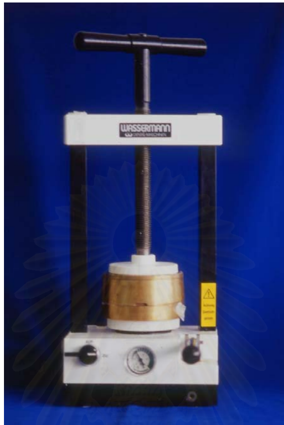
รูปที่ 33 ขณะอัดภาชนะหล่อแบบพินในเครื่องอัดชนิดไฮดรอลิก
