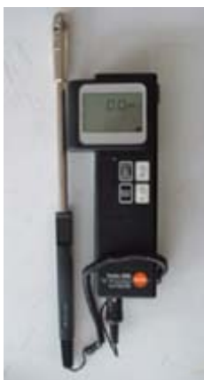
รูปที่ 3.2.6 เครื่องมือวัดความเร็วลม Testo 450 (ที่มา วนัสสุดา ไชยมนตรี (ภาพถ่าย) 11 มีนาคม พ.ศ. 2545)
