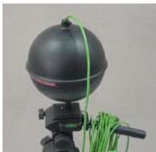
รูปที่ 3.2.2 Globe ทองแดงทาสีดำวางบนขาตั้งกล่อ่ง สำหรับวัดค่า Globe Temperature (ที่มา วนัสสุดา ไชยมนตรี (ภาพถ่าย) 11 มีนาคม พ.ศ. 2545)
