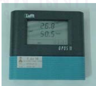
รูปที่ 3.2.4 Data Logger OPUS 10 สำหรับเก็บค่าความชื้นสัมพัทธ์ (ที่มา วนัสสุดา ไชยมนตรี (ภาพถ่าย) 11 มีนาคม พ.ศ. 2545)
