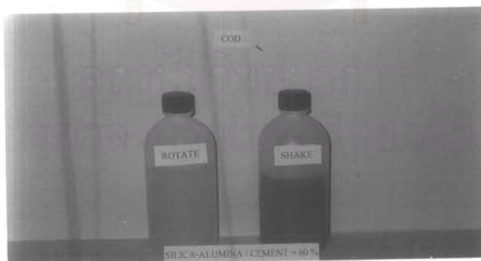
รูปที่ 5.77 ภาพซ้าย แสดงน้ำชะตะกอนจากเครื่องเขย่าแบบหมุน 360 องศา ภาพขวา แสดงน้ำชะตะกอนจากเครื่องเขย่าแบบแนวขวาง
