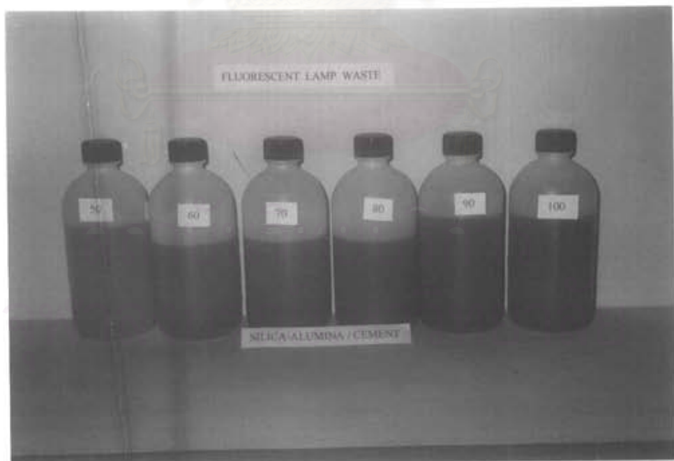
รูปที่ 5.75 ภาพแสดง น้ำระเหยของตัวอย่างซีเมนต์ผสมกากหลอดฟลูออเรสเซนต์ (อัตราส่วนผสมซิลิกา-อะลูมินาที่ใช้แล้วต่อปูนซีเมนต์ 50 60 70 80 90 และ 100%)
