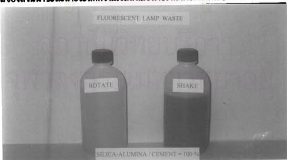
รูปที่ 5.79 ภาพซ้าย แสดงน้ำชะละลายจากเครื่องเขย่าแบบหมุน 360 องศา ภาพขวา แสดงน้ำชะละลายจากเครื่องเขย่าแบบแนวขวาง
