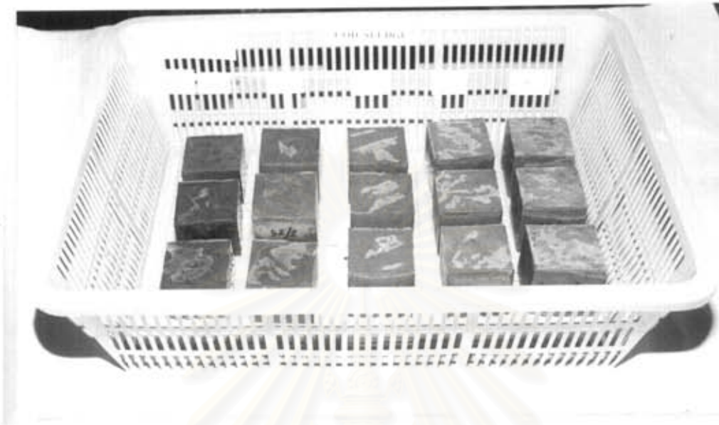
รูปที่ 5.5 แสดงก้อนซีเมนต์ผสมซีตีกา-อะลูมินาที่ใช้แล้วต่อปูนซีเมนต์ 0 - 40% และตะกอนโลหะหนักต่อวัสดุประสาน 0.75
