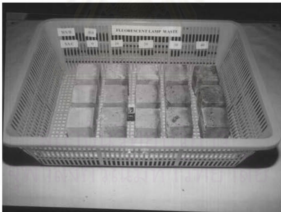
รูปที่ 5.14 แสดงก้อนซีเมนต์ผสมซิลิกา-อะลูมินาที่ใช้แล้วต่อปูนซีเมนต์ 0 - 40% และตะกอนโลหะหนักต่อวัสดุประสาน 0
