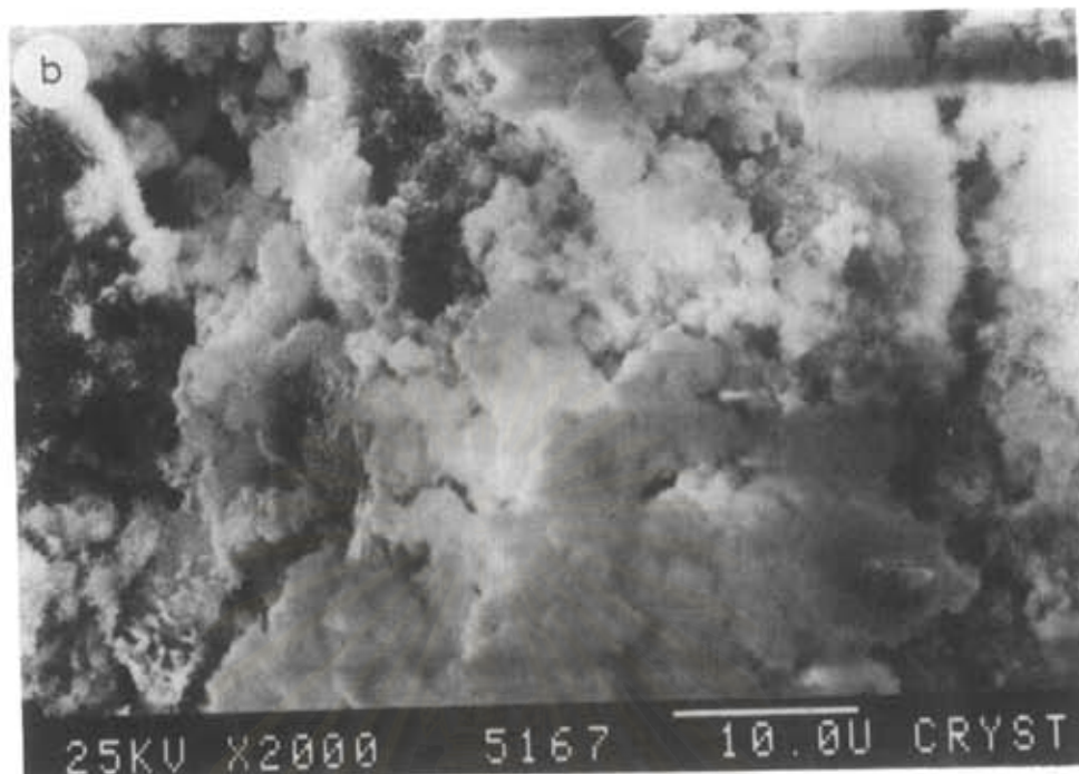
รูปที่ 3.10 แสดงภาพถ่าย SEM ของตัวอย่างที่เป็นซีเมนต์ผสมซิลิกาที่มีพรอทผสมอยู่ (Poon, 1985)
