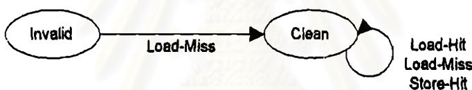
รูปที่ 2.15 D-Cache write-through mode state diagram
